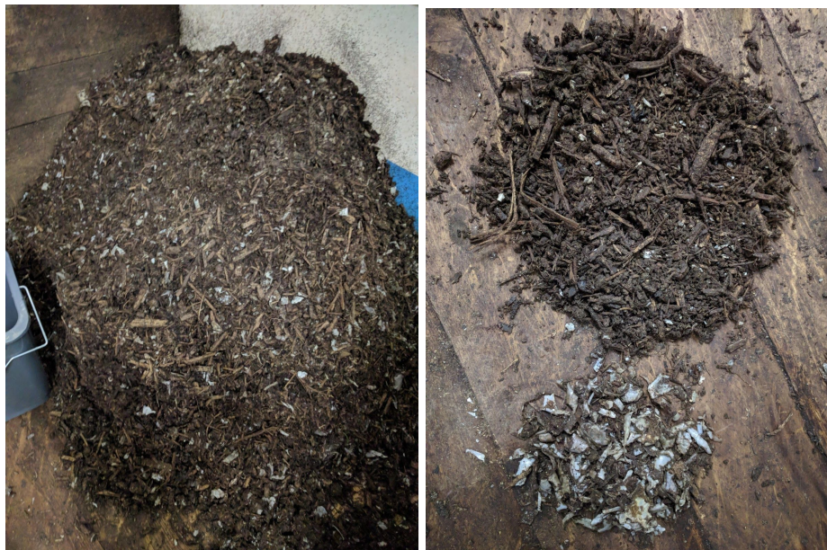
À gauche : Lot du compost avec PLA isolé; À droite : séparation des paillettes de PLA résiduelles dans un échantillon
