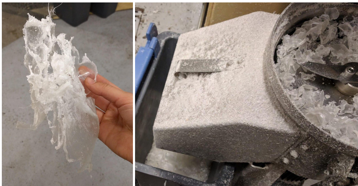
À gauche : Bouteille en PLA coincée ; À droite : Dépôt de poussière lors du broyage
