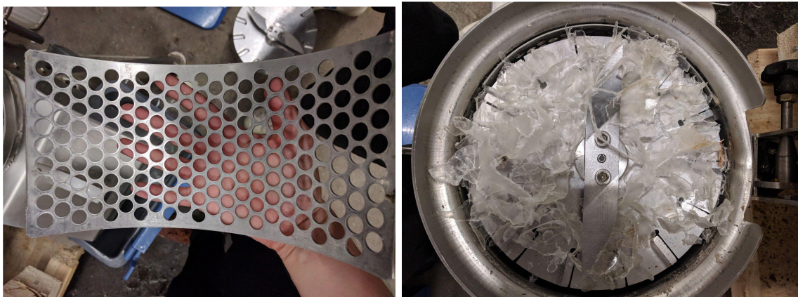
À gauche : Exemple de grille ; À droite : Intérieur du Voran avec lames et paillettes PLA après broyage
